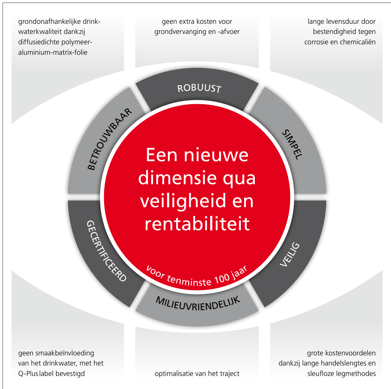
1 In een oogopslag de voordelen van GEROfit® REx Barrier Pipe
